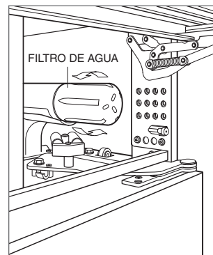
Extracción del filtro de agua.
